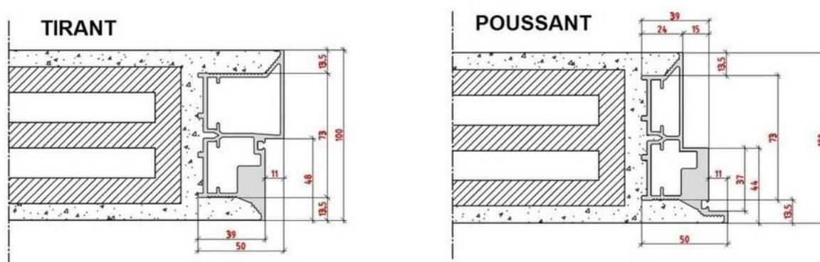
La **version 70 mm** s'adapte à toutes les épaisseurs et types de cloisons à partir de 66 mm sauf pour les cloisons en placoplâtre de 95 et 98 mm et les cloisons pleines (briques plâtrées, siporex, carreaux de plâtre) de 100 mm.
